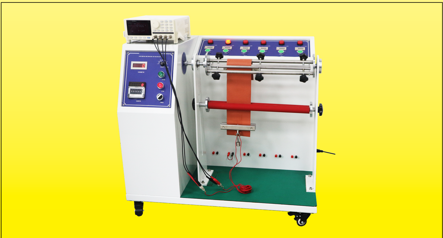
Flexible Silikonheizung während des Biegetests
