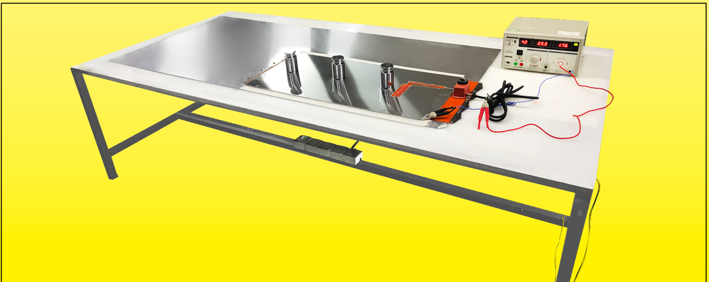
Messgeräte für den Gesamtleckstrom im kalten Zustand
