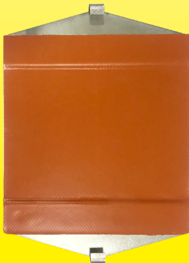
Probe für den Reißkrafttest
