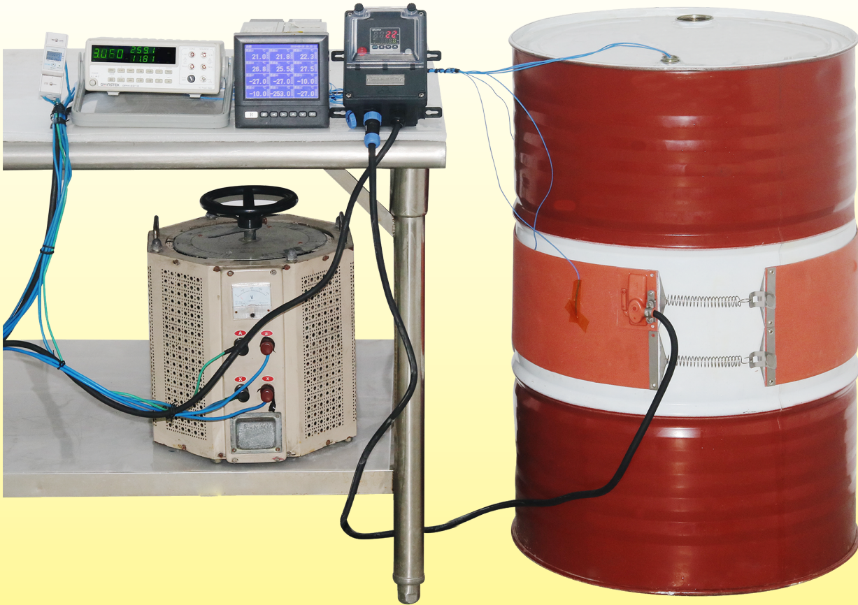
Temperaturverlauf in Abhängigkeit von der Zeit eines 220Liter-Metalfasses, gefüllt mit Wasser, beheizt durch einen Silikonheizgurt 200mm breit, ohne Wärmeisolation, Leistung 1500W (Oberflächenlast 0,5W/cm 2 ).
